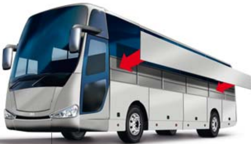
Montáž vnějšího opláštění na kostru karoserie v automobilovém průmyslu
