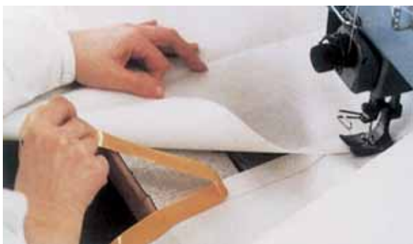
Oboustranná lepicí páska 3M přidržuje plachtovinu před jejím sešítím.
